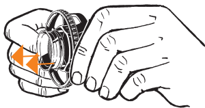
Sacar el Cilindro de la Cámara de Relleno hacia arriba fuera de la Carcasa
