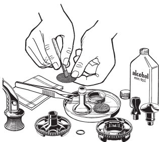
Pulizia manuale con alcool isopropilico (70 %) oppure detersivo per stoviglie
