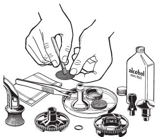
Manuelle Reinigung mit Isopropylalkohol (70%) oder Spülmittel
