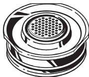
Die in den Dosierkapseladapter eingesetzte Dosierkapsel
